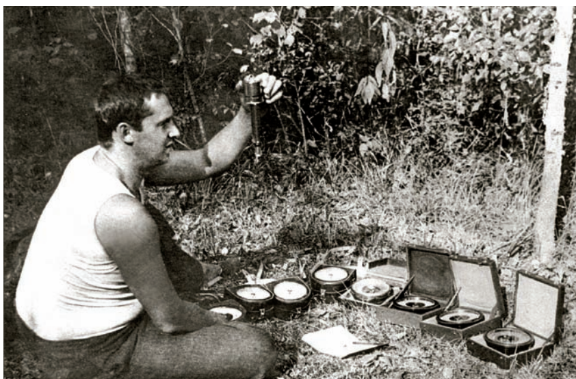
1937 г., Средняя Россия. Высотная привязка пункта с помощью барометров
