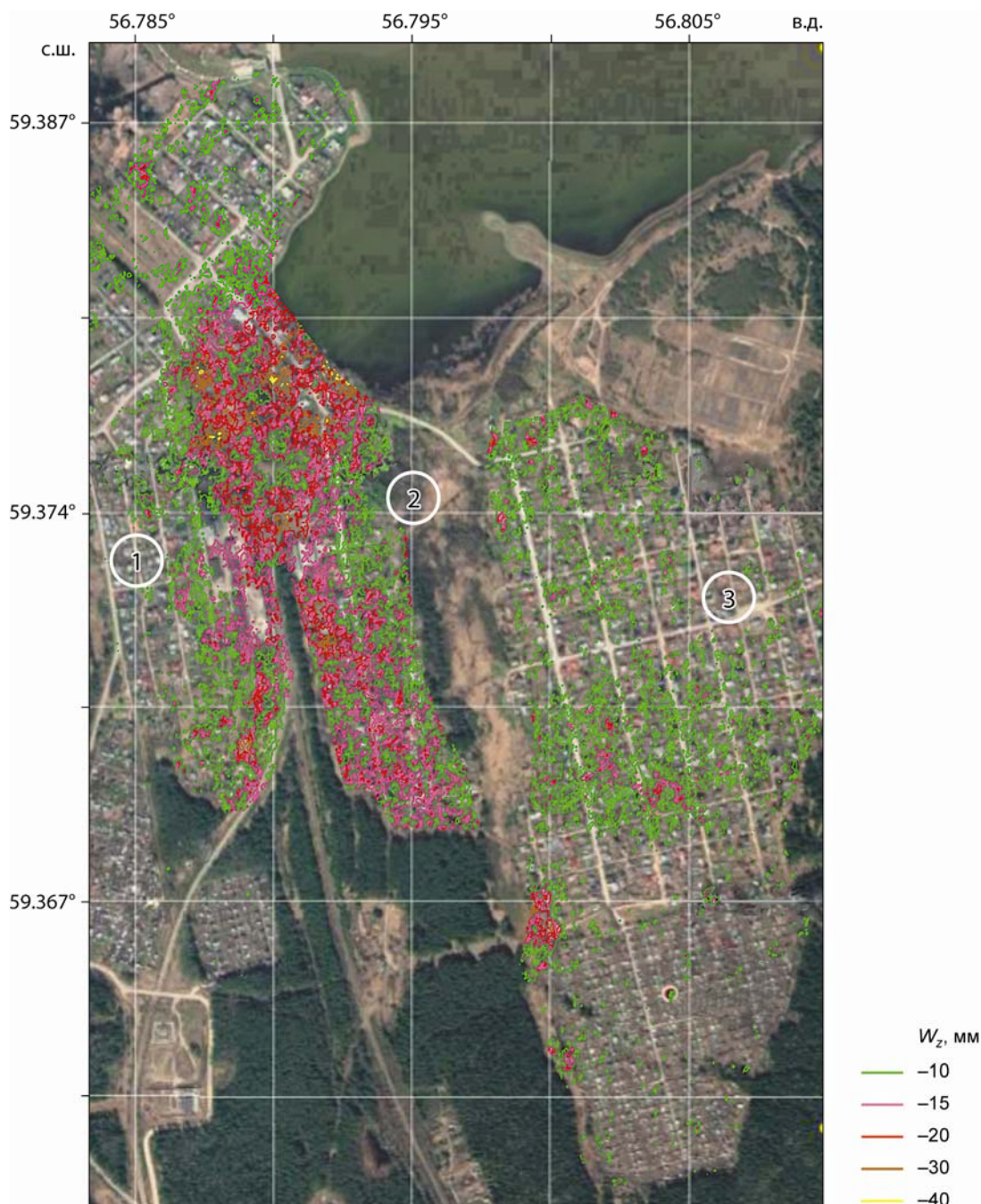
Рис. 2. Карта субвертикальных смещений W_z за период 25.07–27.08.2020 г. на территории поселков 1, 2, 3, расположенных к югу от г. Березники. Оседания показаны в областях с когерентностью более 0.2
