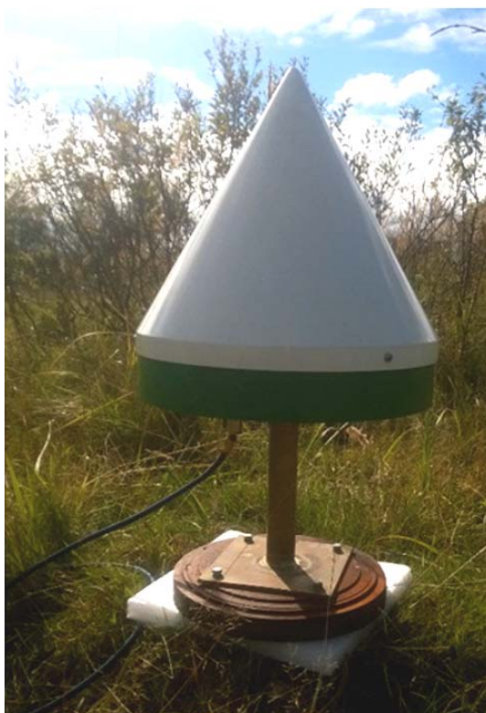
Рис. 1. Размещение на земной поверхности одной из высокоточных приемных антенн RingAnt-G3T ; вторая антенна располагается аналогичным образом на удалении ~100–120 м
