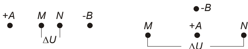
Рис. 1. Схемы симметричной установки, используемой в методе ВЭЗ ( слева ), и дифференциальной MAN , в которой питающее заземление B отнесено в практическую бесконечность ( справа ). A, B – питающие заземления; M, N – приемные; \Delta U – измеряемая разность потенциалов
