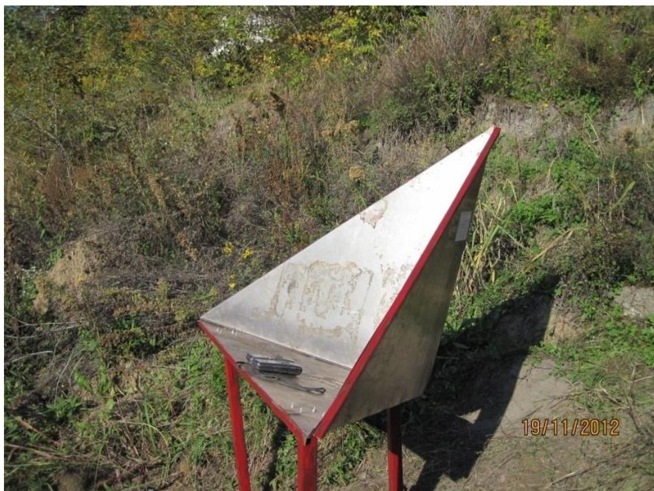
**Рис. 5.** Общий вид уголкового отражателя, установленного на оползневом склоне
