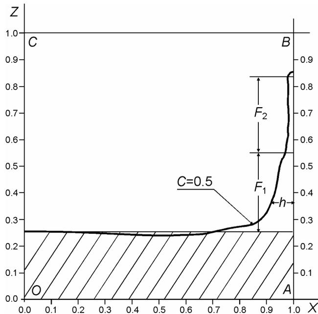
Поверхность слоя 2A в модели вязкого увлечения базальтового материала от оси рифтовой долины на медленно раздвигающемся срединно-океаническом хребте, рассчитанная как изолиния  $C=0.5$ . В интервале глубин  $F_1$  мощность внешнего базальтового слоя коры  $h$  уменьшается с расстоянием от оси рифтовой долины.  $F_2$  – интервал глубин, в пределах которого мощность коры  $h$  неизменна. Заштрихована область питания слоя 2A материалом коры
