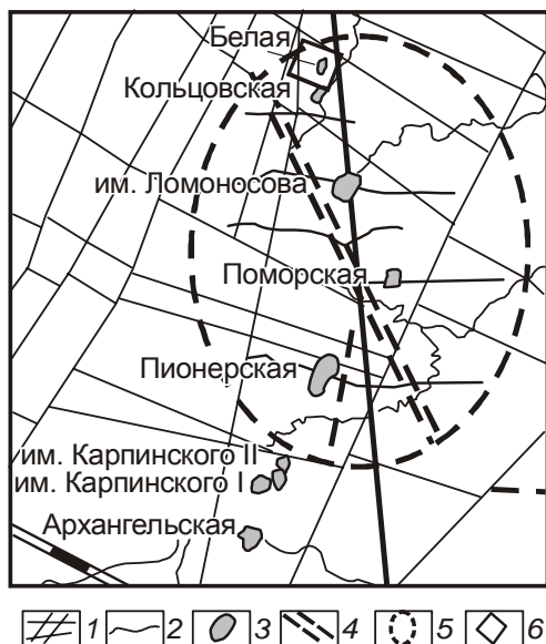
Рис. 1. Фрагмент тектонической карты одного из участков Архангельской алмазоносной провинции с уточнениями по результатам наземной электроразведки МПП
