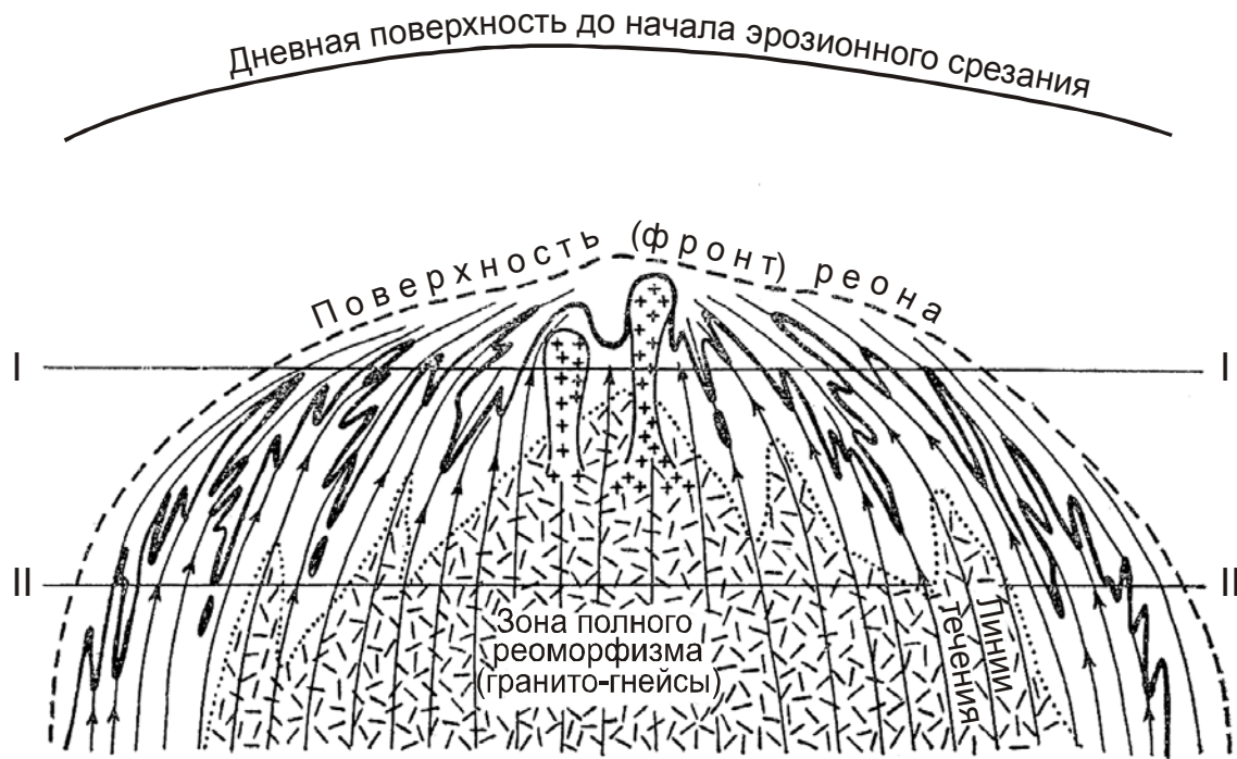
Рис. 2. Схематический вертикальный разрез складчатых овалов, демонстрирующий характер течения материала в поднимающемся реоне. Линии I-I и II-II соответствуют разным уровням эрозионного среза, наблюдаемым на Алданском щите (I-I) и в Южной Африке (II-II). Линия вверху рисунка – условное положение дневной поверхности до начала эрозионного срезания (по [Салоп, 1982] с изменениями)
