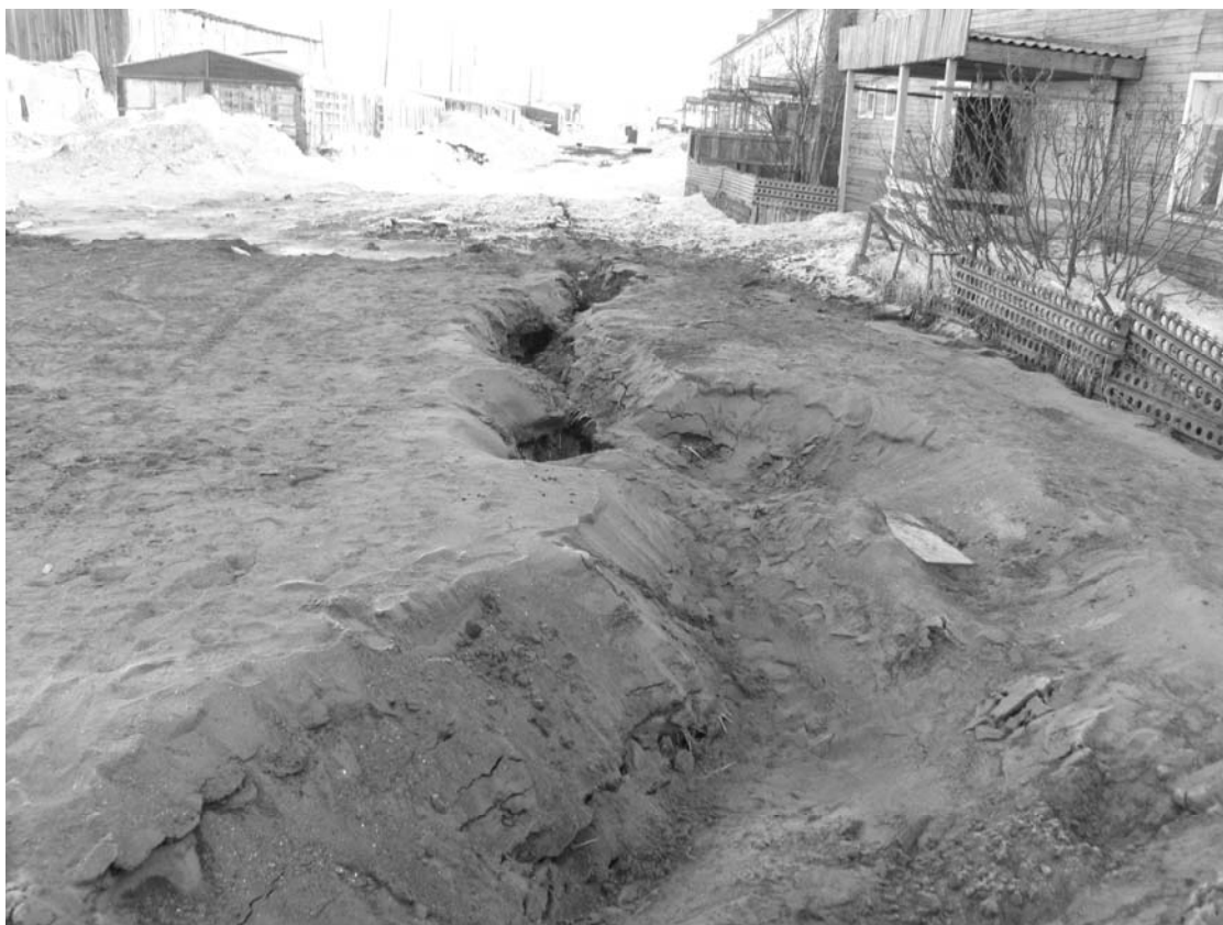
Рис. 2. Выбросы обводненного песка вдоль вибрационной трещины в пос. Корф (фото Е.А. Рогожина)
