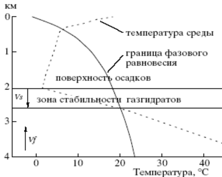
Рис. 1. Принципиальная схема, иллюстрирующая механические, гидродинамические и тепловые условия процессов накопления и уплотнения осадков и аккумуляции газгидратов в зоне их стабильности.
