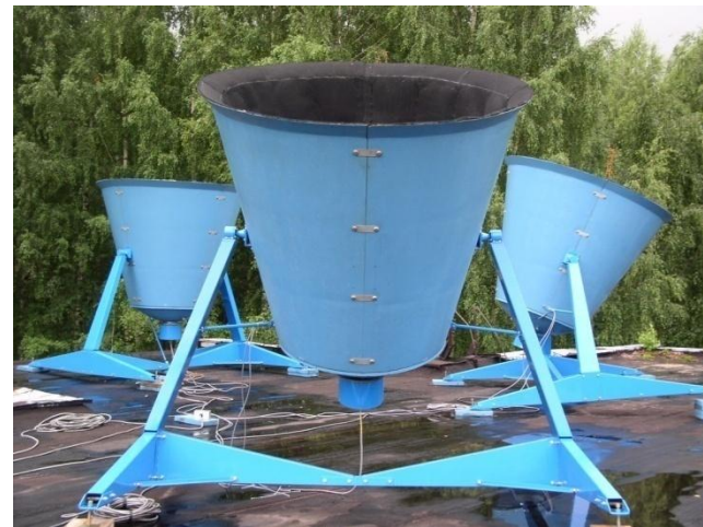
Акустический доплеровский трёхкомпонентный локатор (содар) «ВОЛНА-3» : рабочая частота 1700 Гц, высотный диапазон 50 - 800 м, диапазон измерения средней скорости ветра от 0.3 до 20 м/с, период цикла зондирования 16 с, разрешение по высоте 5 м.
