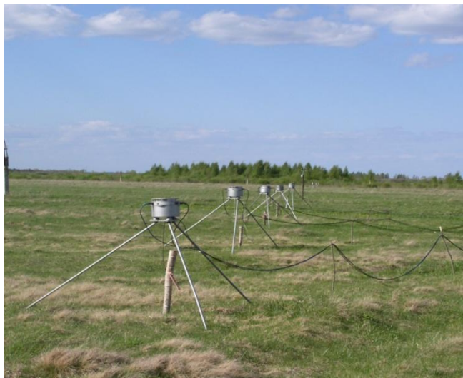
Электростатические флюксометры типа «field mill»: тактовая частота 10 Гц, пороговая чувствительность 0.1 В/м .
