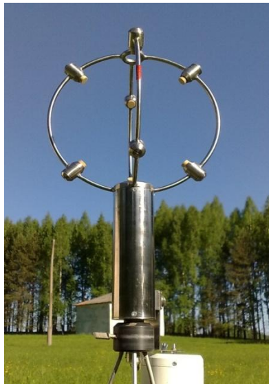
Ультразвуковая метеостанция «Метео-2Н», тактовая частота 10 Гц .
