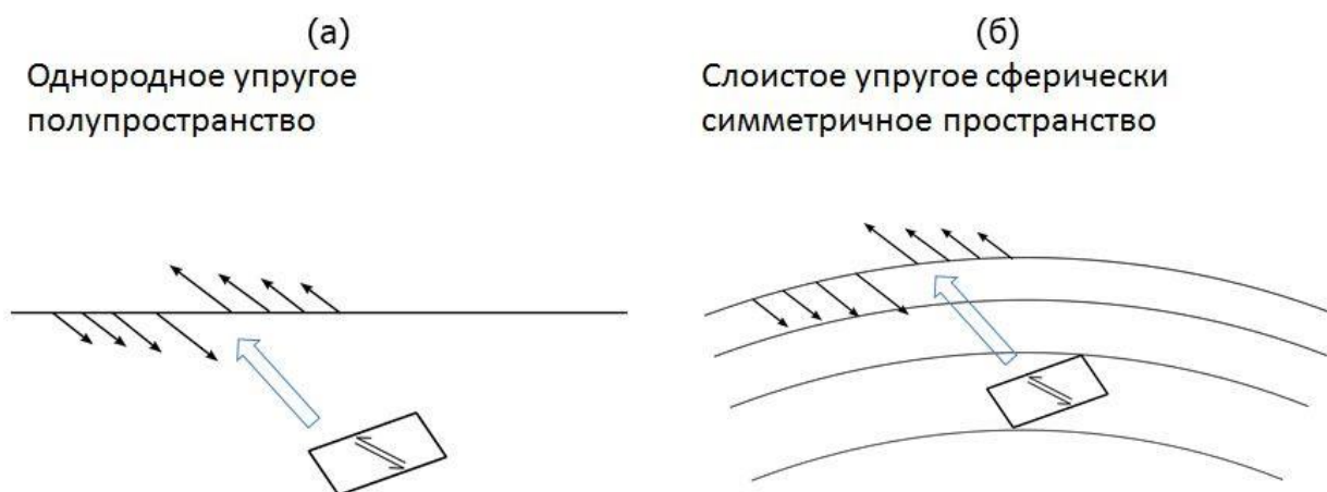
Рис.2.2. Схемы для решения прямой задачи моделирования деформаций вследствие дислокации по заглубленному разрыву прямоугольной формы. (а) [Okada, 1985], (б) [Pollitz, 1996].
