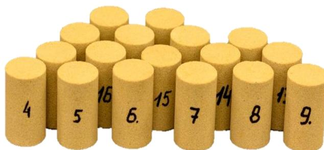
Рисунок 3.2 – Фотография образцов песчаника Бентхаймер.
