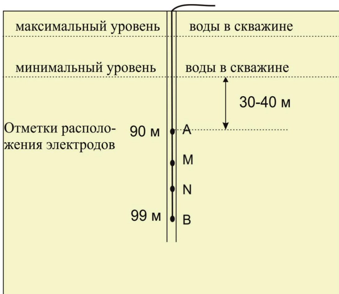
Рис. 3.2.1. Схема расположения питающих (AB) и приемных (MN) электродов в скважине №1.
