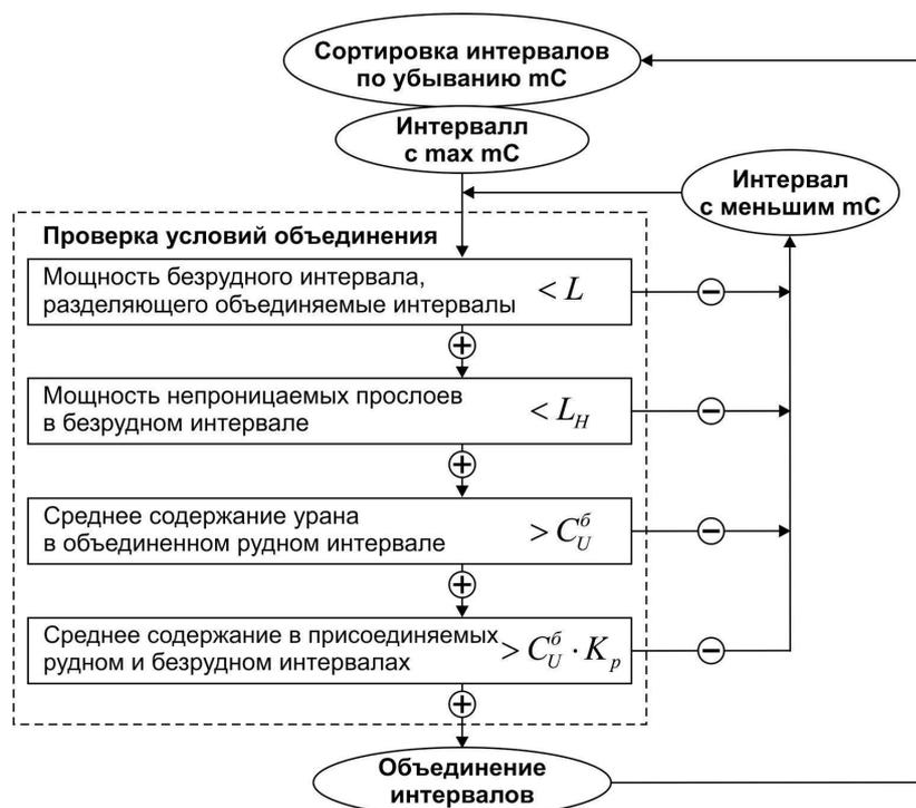
**Рис. 10.** Алгоритм морфологического объединения рудных интервалов.
