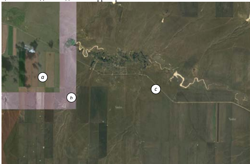
Рис. 1. Примеры появления ложных линеаментов на территории Ставрополя: a – границы сельскохозяйственных угодий, b – артефакты склейки, c – дороги
