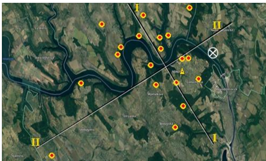
Рис. 3. Карта-схема (на основе космоснимка Google) сейсмичности района Днестровской ГАЭС-1 за период 2014-2018 гг. Здесь: красно-желтые кружки – эпицентры землетрясений различной магнитуды; желтый треугольник – сейсмическая станция «Новоднестровск», белый круг с крестом – макросейсмический эпицентр землетрясения 22.10.2006 г. (показаны условные профили I-I и II-II)
