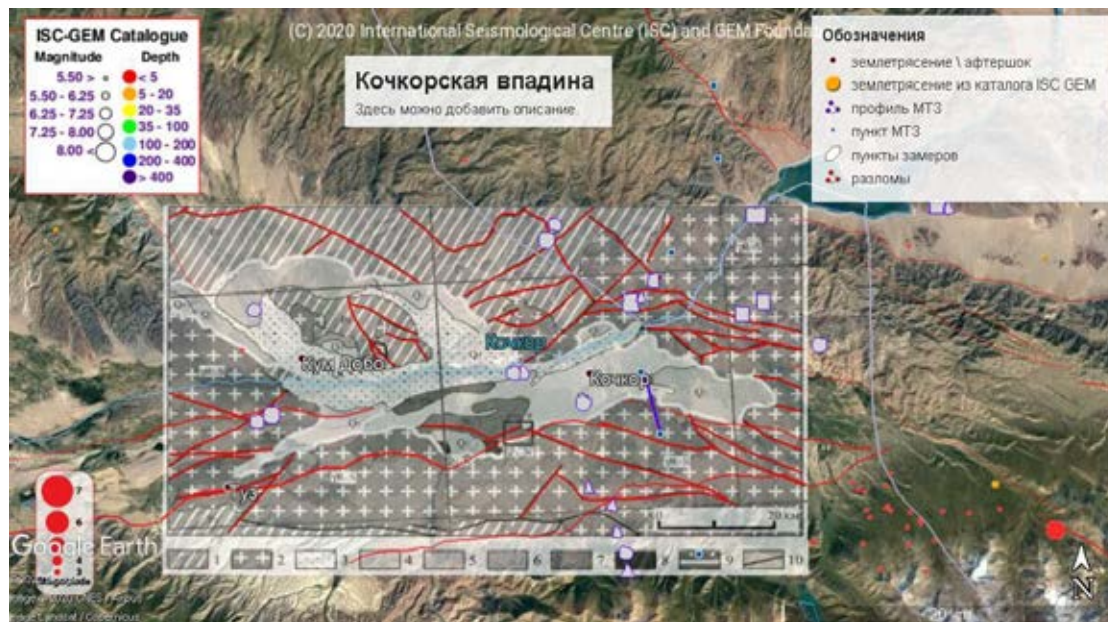
Рис. 1. Совмещенная карта Кочкорской впадины с нанесенной информацией о геологическом строении и разломах по [Леонов, Пржиялговский, Лаврушина, 2018; БД активных разломов Евразии, 2018], МТЗ по [Баталева и др., 2017], землетрясениях по данным Международного сейсмологического центра [Каталог ISC-GEM, 2020], пунктах замеров тектонических напряжений в палеозойских и более древних образованиях по [Маринин и др., 2018] в Google Earth
