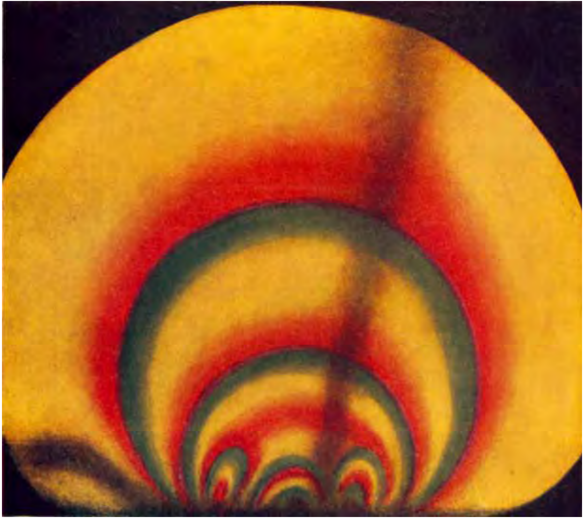
Фиг. 119. Фотография изохром и изоклин в модели слабо развитой антиклинали поперечного изгиба из упругого студня желатины. Ширина жесткой глыбы, деформирующей толщу, много меньше мощности последней
