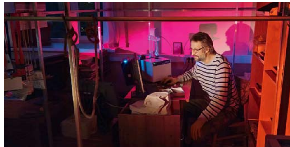
Кандидат геолого-минералогических наук Андрей Шацлло измеряет анизотропию магнитной восприимчивости на капнометре МФК1-ФА.
