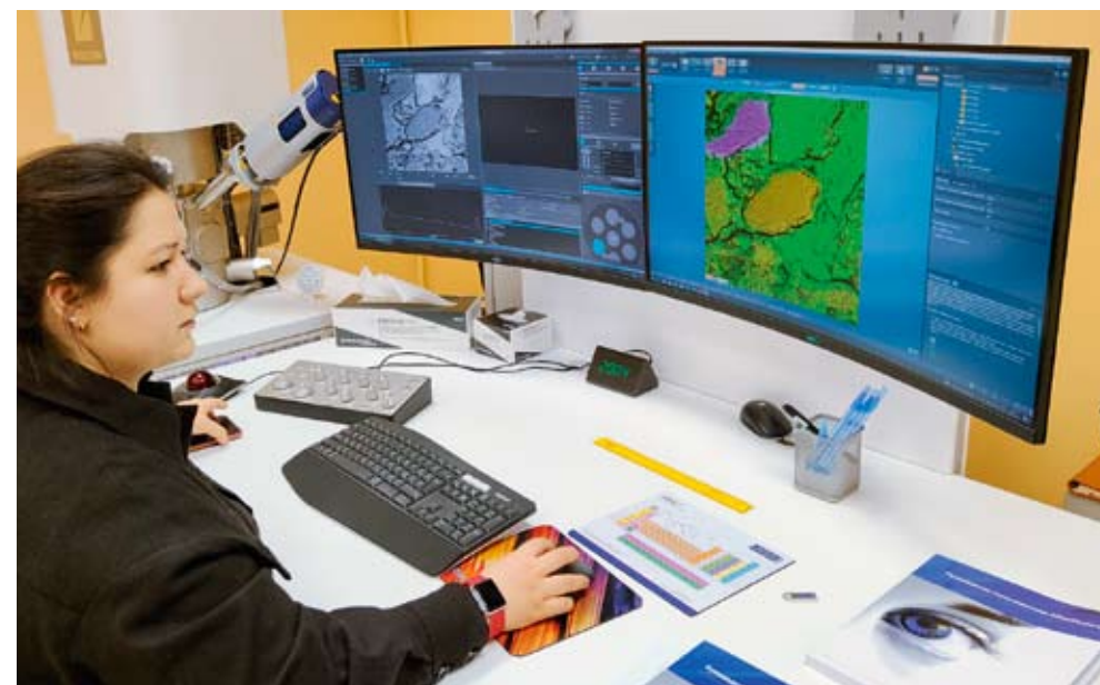
Современной геофизике при изучении горных пород и минералов не обойтись без электронного микроскопа. Исследование проводит Татьяна Багдасарян.
