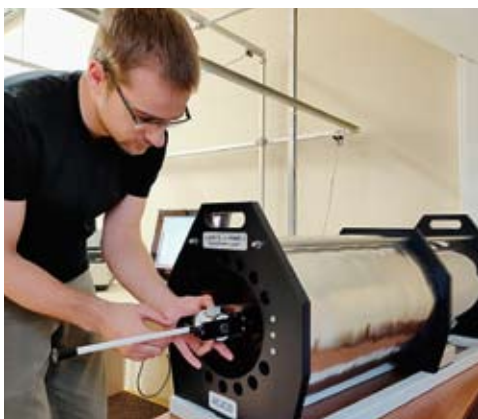
Для изучения магнитных свойств горной породы образцы размагничивают переменным магнитным полем и затем измеряют остаточную намагниченность с помощью демагнетайзера LDA-5. Исследования проводит Александр Пасенко.
