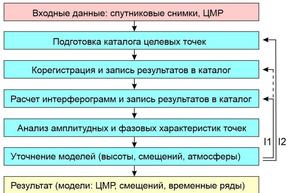
Рисунок 1.4 – Рекомендуемая схема обработки интерферометрических данных методом IPTA
