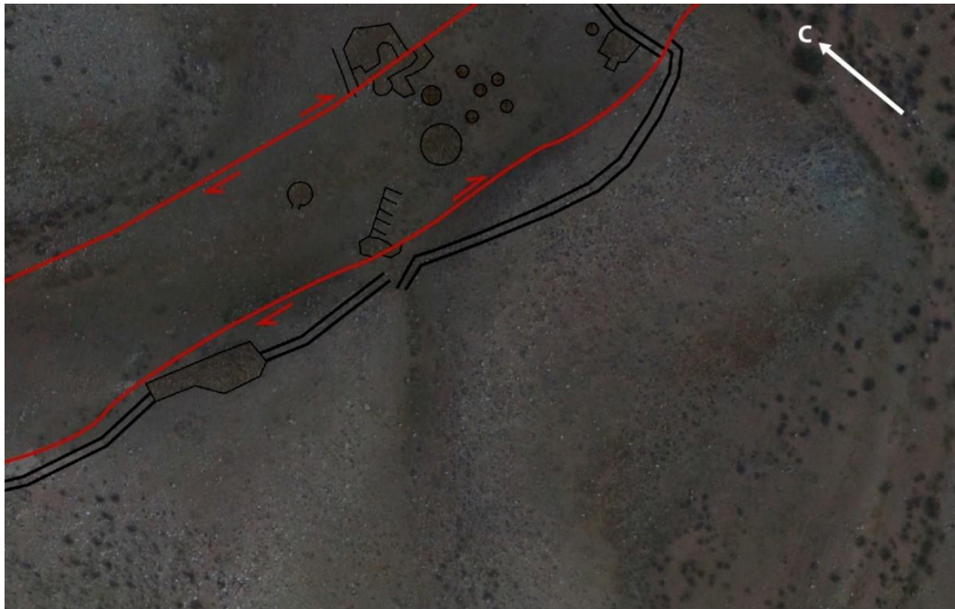
Рисунок 3.21. Параллельные разломы в храмовой части комплекса с разрушением фундаментов построек (вид сверху) (А.А. Стрельников, А.М. Корженков, 2020)
