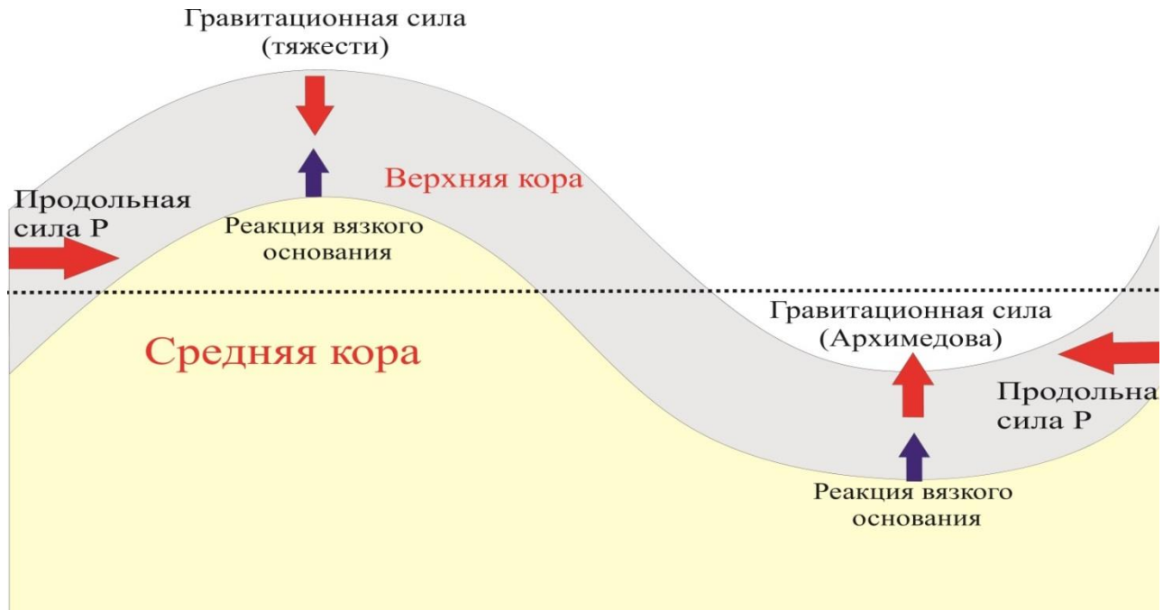
Рис. 3.4. Силы, воздействующие на Верхнюю кору в балочном решении на общей схеме модели.
