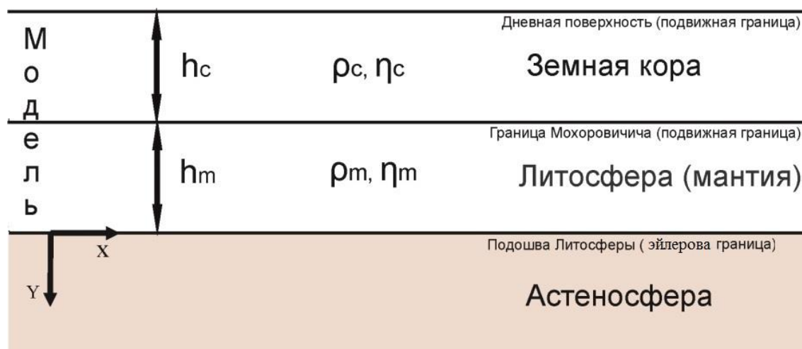
Рис. 1.1. Общая схема двуслойной модели (задача о влиянии астеносферной конвекции).
