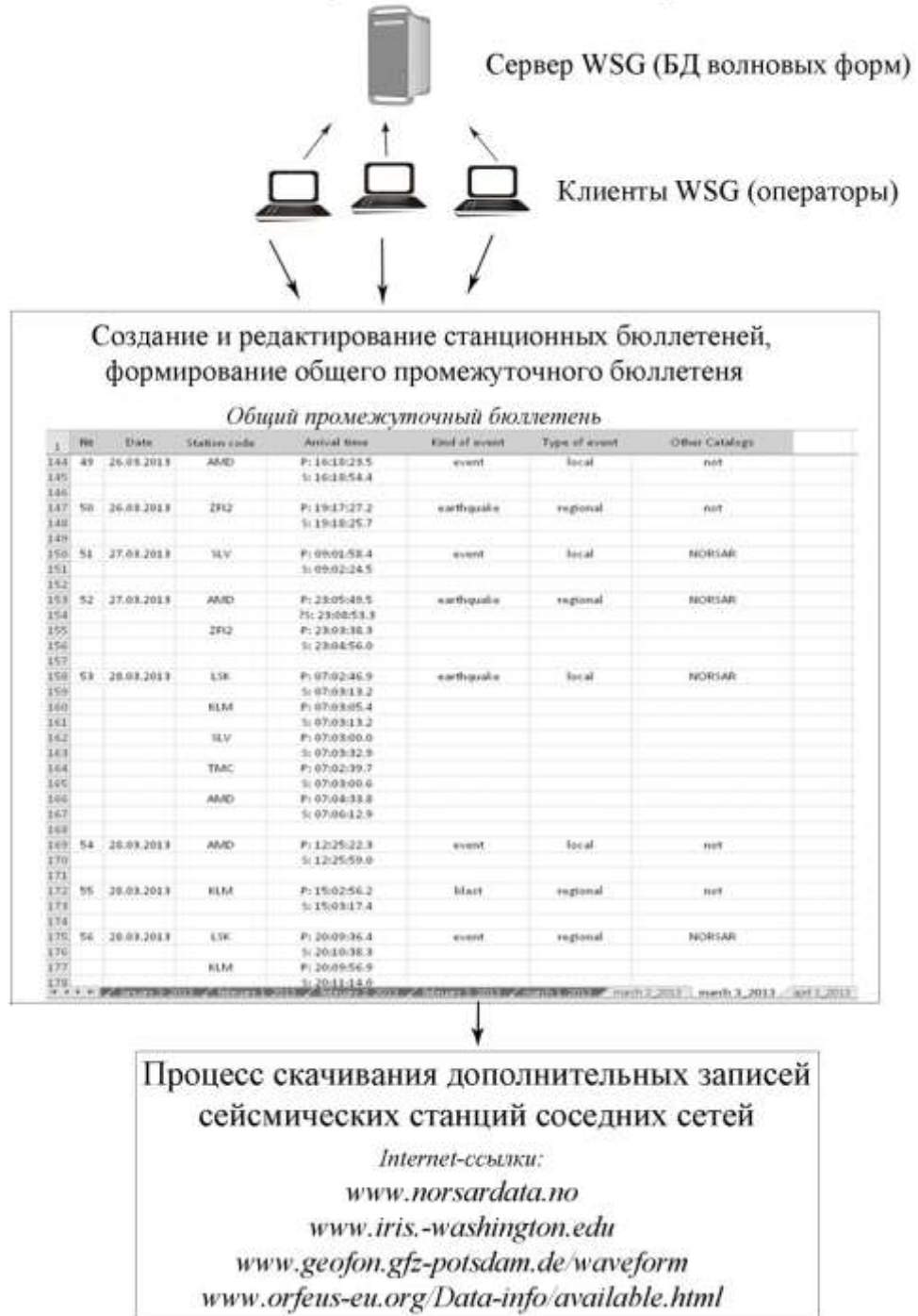
Рис. 2.3. Схема первого этапа обработки региональных сейсмических событий
